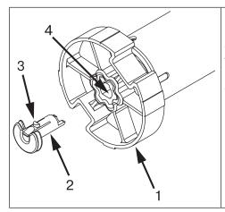
Inserire la ruota di trascinamento (1) sul rullo di trasmissione dell'operatore tubolare. La posizione d'innesto della sicurezza della ruota di trascinamento (2) è determinata dalla sua forma. Durante l'innesto della sicurezza della ruota di trascinamento (2) nel foro d'arresto (4) prestare attenzione al corretto scatto della protuberanza d'arresto (3). Questo viene confermato da un clic. Tirare la ruota di trascinamento (1) per verificare il corretto fissaggio della sicurezza.
