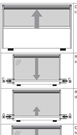
Con il tasto SALITA raggiungere innanzitutto il fine corsa alto fino all'arresto automatico dell'operatore tubolare.
