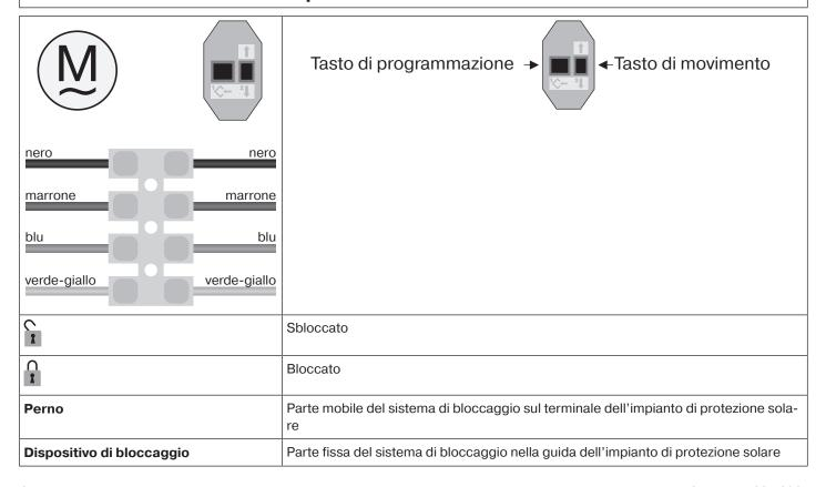
Collegare i cavetti di collegamento dell'operatore tubolare dello stesso colore con quelli del set di regolazione (Cod. art. 4935 200 011 0) e attivare la tensione di rete.
