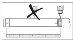
Per fissare l'operatore contro uno spostamento assiale, si consiglia di avvitare la ruota di trascinamento al rullo.
