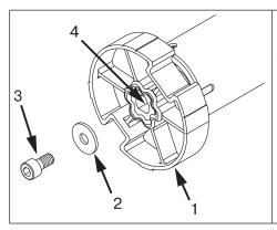
Inserire la ruota di trascinamento (1) sul rullo di trasmissione dell'operatore tubolare. Per il montaggio utilizzare una vite M6x12 (3) con relativa rondella (2) e fermo vite adatto. Foro filettato (4)
