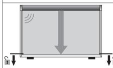
Con il tasto DISCESA spostare il perno verso il basso allontanandolo del dispositivo di bloccaggio e arrestare l'operatore tubolare. Premere quindi il tasto programmazione.
